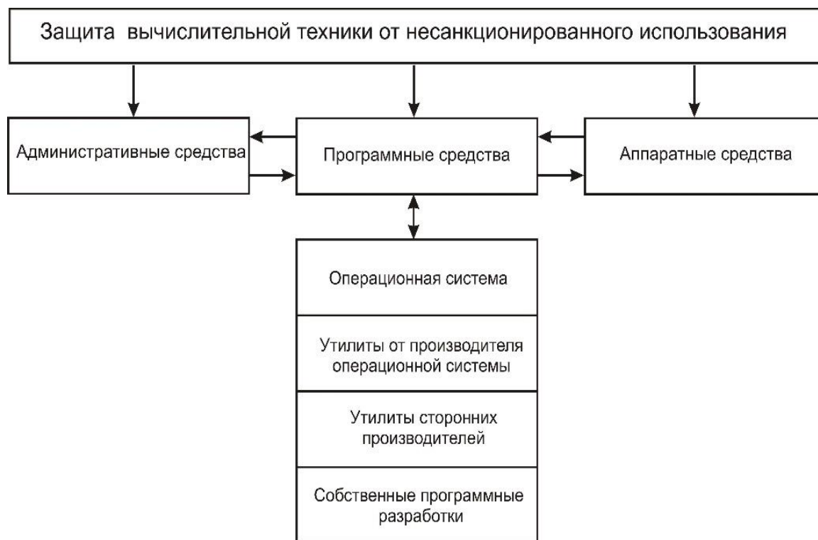
Рисунок 1 – Защита вычислительной техники от несанкционированного использования
