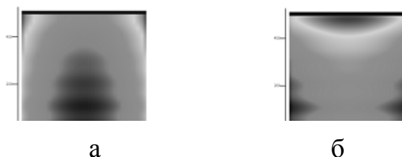
Рисунок 2 – Картины распределения поля в центральных сечениях цилиндра из органического стекла: сечение ZOY (а), ZOX (б).
