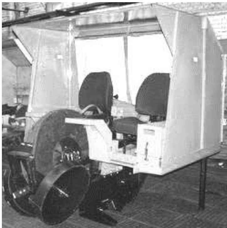
Рисунок 1.68 – Лесопосадочная машина МЛЮ-1А
