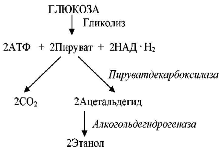
Рисунок 3.1 – Схема спиртового брожения
