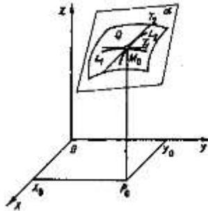
Рис.3. Касательная плоскость
