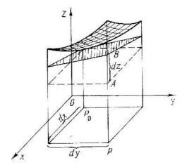
Рис.1. Геометрический смысл дифференциала
