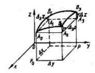
Рис.1. Частные и полное приращения функции двух переменных
