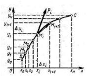
Рис.1. Задача о работе переменной силы
