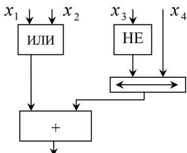
реализуется булевой функцией  $f(x_1, x_2, x_3, x_4) = (x_1 \vee x_2) + (\bar{x}_3 + x_4)$
