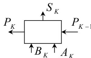
Здесь  $S_k$  - получаемая сумма,  $P_{k-1}$  - перенос из младшего разряда,  $P_k$  - перенос в старший разряд. Выходы  $S_k$  и  $P_k$  представляют собой значения некоторых функций, определенных на множестве всевозможных наборов значения входов  $A_k, B_k, P_{k-1}$ , т.е.  $S_k = f(A_k, B_k, P_{k-1})$ ,  $P_k = \varphi(A_k, B_k, P_{k-1})$ .
