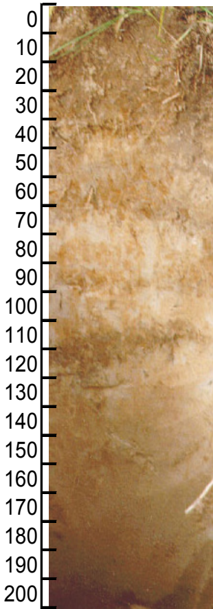
Рисунок А17. Повышение центральной поймы (точка 13 на профиле). Тип почвы: аллювиальная дерново-глеявая песчаная почва, развивающаяся на связных песках, подстилаемых рыхлым песком.
